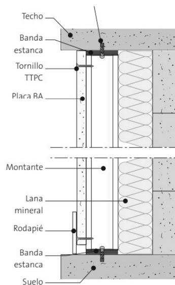
La separación de las viviendas **en escalera y elementos comunes**, se realizará mediante pared de ladrillo perforado acústico de 11 cm de espesor, enlucido de yeso en la cara de la escalera y trasdosado interiormente sobre perfilería con panel de yeso laminado tipo Pladur o similar.
