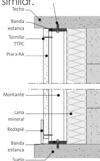
La separación de las viviendas **con escalera y elementos comunes**, se realizará mediante pared de ladrillo perforado acústico de 11 cm de espesor, enlucido de yeso en la cara de la escalera y trasdosado interiormente sobre perfilería con panel de yeso laminado tipo Pladur o similar.
